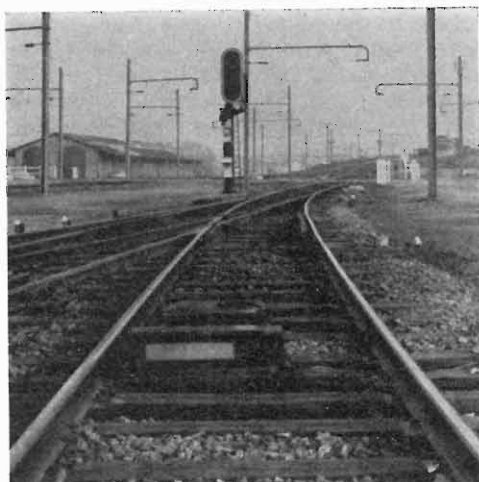
Foto 4 - Misura di velocità per asservimento di un freno di via in una stazione di smistamento. Il radar appare in primo piano, sulla linea.
